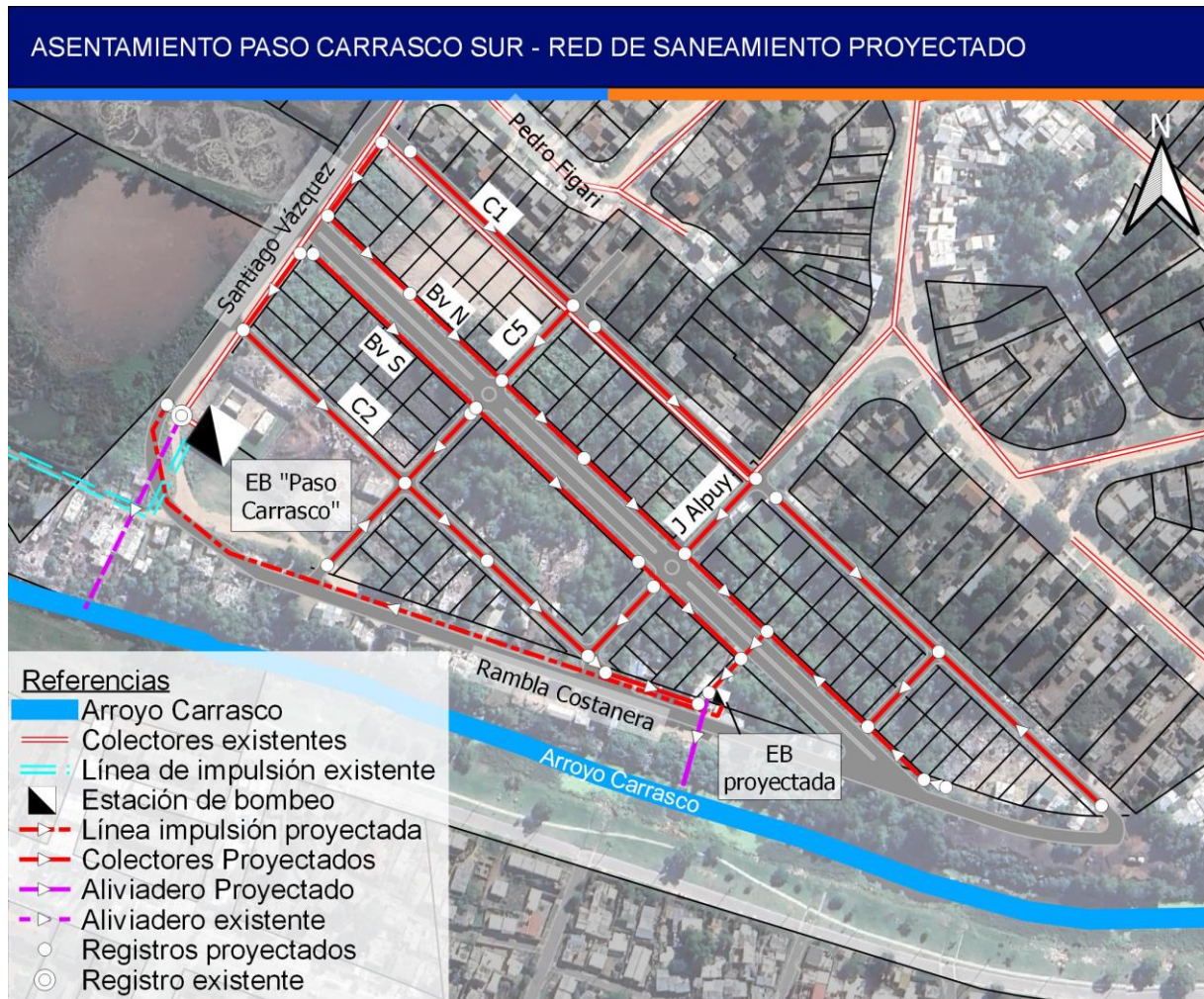
Figura 3-1: Esquema red de colectores proyectados.
