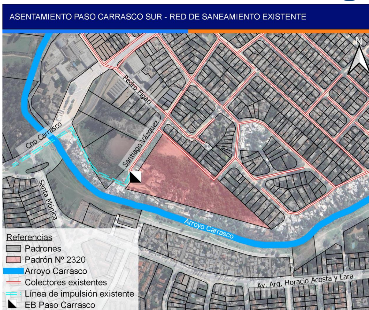
Figura 2-1: Esquema red de saneamiento existente.
